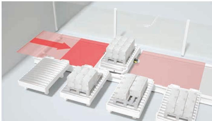
**Lösung:** Am Querverschiebewagen ist in beiden Fahrtrichtungen jeweils ein Bereichs-Sicherungssystem mit einem Sicherheits-Laserscanner installiert. Das autark arbeitende System erkennt selbstständig die Annäherung an die begrenzende Wand und verkleinert das Schutzfeld des Sicherheits-Laserscanners automatisch.
